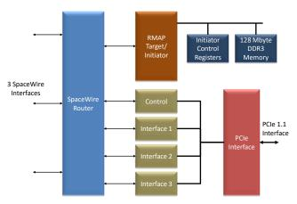
SpaceWire PCIe Block Diagram
