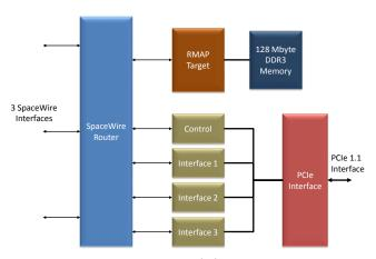
SpaceWire PCIe Block Diagram
